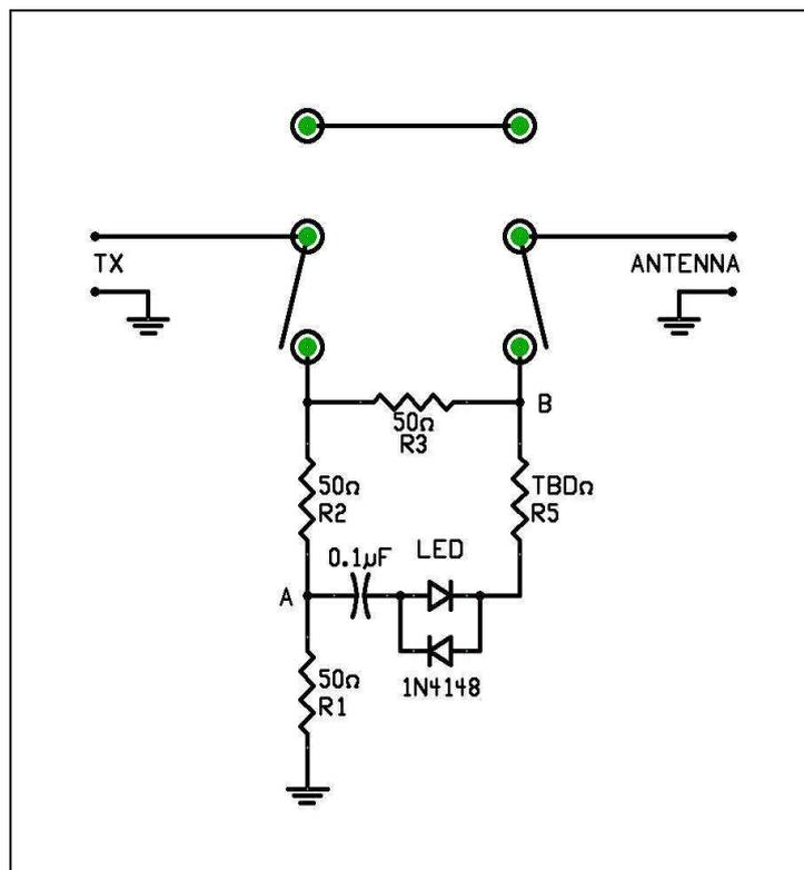
le resistenze da 50 Ohm possono essere ottenute con due da 100 Ohm in parallelo, così si raddoppia la potenza dissipata.
