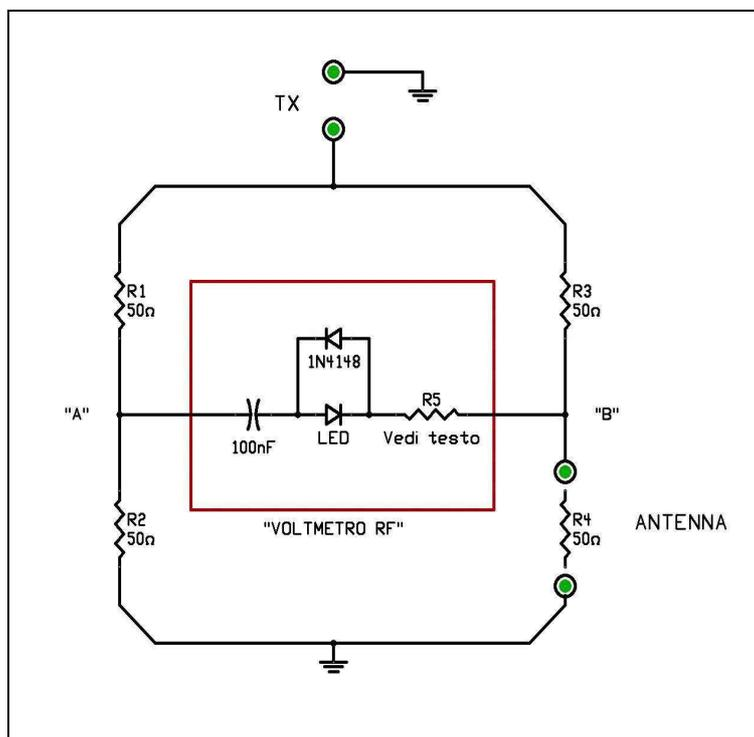
come vedete siamo di fronte a un normale "ponte di Wheatstone", dispositivo elettrico messo a punto da Charles Wheatstone nel 1833 per misurare il valore di una resistenza elettrica.
